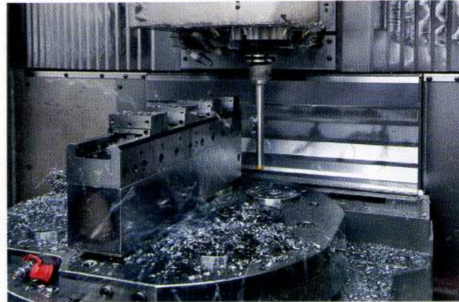
Der AMF-Cleaner nutzt die Funktionen von CNC-Maschinen und Bearbeitungszentren für schnelles und preiswertes Reinigen und Trocknen
