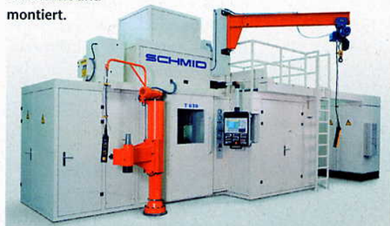
Bild 2: Produktionsanlage für große Taumelumformteile werden applikationsbezogen entwickelt und montiert.
