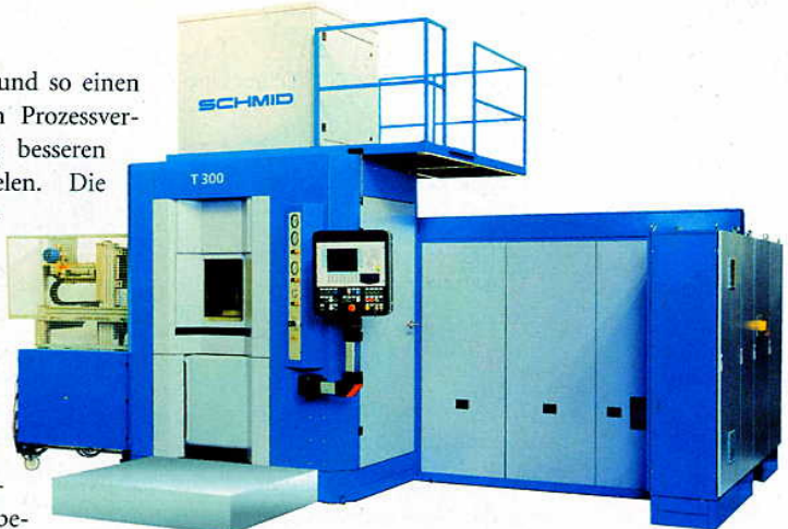
Bild 1: Mit der Taumelpresse T300 werden die Produktionsprozesse der Industrie optimal unterstützt; extreme Massivumformung in kürzester Zeit wird mit dieser Anlage ermöglicht.
