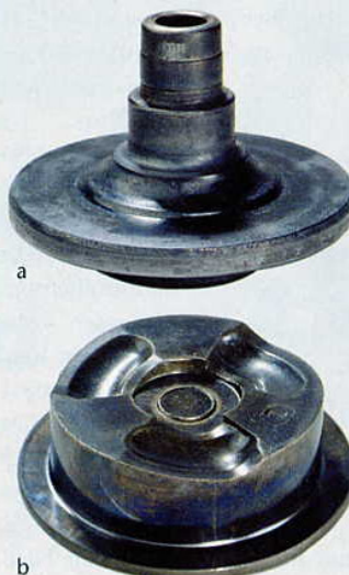
Bild 5: a die Halbwarmumformung von Radnaben ohne Grat hat sich als wirtschaftliches Produktionsverfahren durchgesetzt, b komplexe Kurvenformen in kaltem Zustand hergestellt, weisen hohe Oberflächengüten und höhere Festigkeiten auf.
