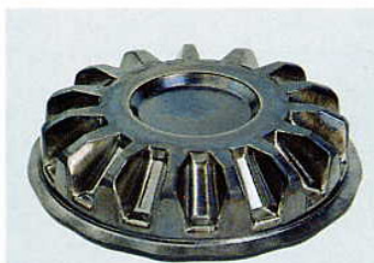
Bild 3: Im Taumelverfahren umgeformte Kegelräder mit fertig geformten Zahnflanken weisen deutlich bessere Belastungswerte auf als herkömmlich geschmiedete.
