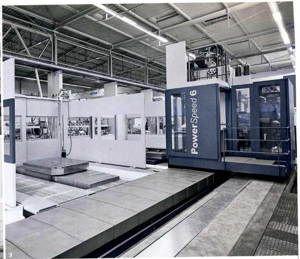
**1** Mit einem ganzen Bündel an Maßnahmen haben die Experten der SHW Werkzeugmaschinen GmbH die Power-Speed-Baureihe verbessert. **2** Bei kleinen Losgrößen, wie sie bei SHW Bearbeitungstechnik an der Tagesordnung sind, erhält der schnelle Eilgang der Power Speed 6 große Bedeutung. **3** Das Maschinenbett auf der Power Speed 6 wurde auf 1220 mm verbreitert. Dadurch lässt sich die Quattro-Energiekette der X-Achse in das Maschinenbett integrieren.
