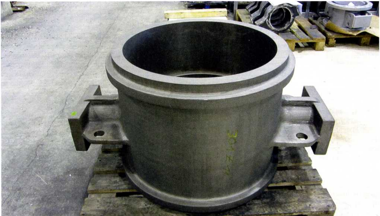
Bild 1: Rund 650 kg bringt der aus Stahlguss gegossene Rohling der Absperrklappe auf den Werkstücktisch des Bearbeitungszentrums.
