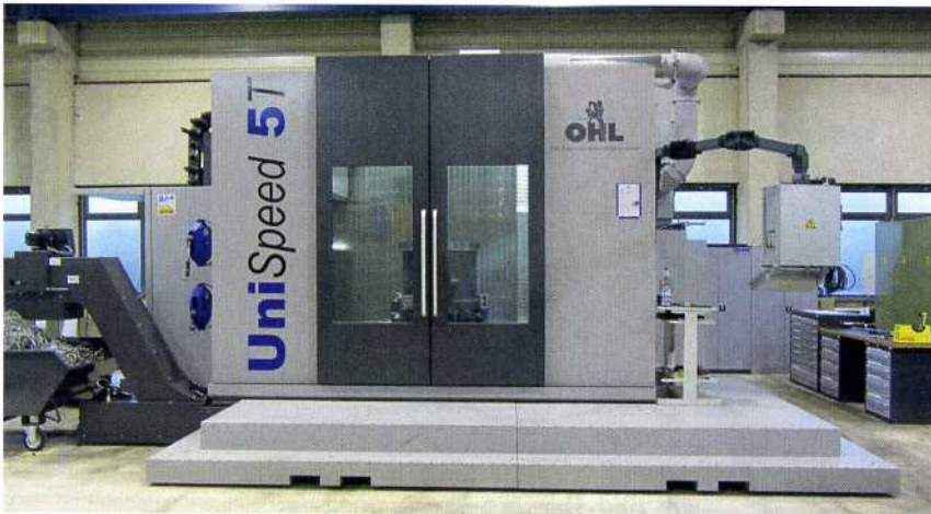
Bild 2: Das Dreh-Fräszentrum der SHW Werkzeugmaschinen ist mit Verfahrwegen von X = 2000 mm, Y = 1300 mm und Z = 1300 mm für die Bearbeitung von Werkstücke bis zu einem Gewicht von 6 t geeignet.
