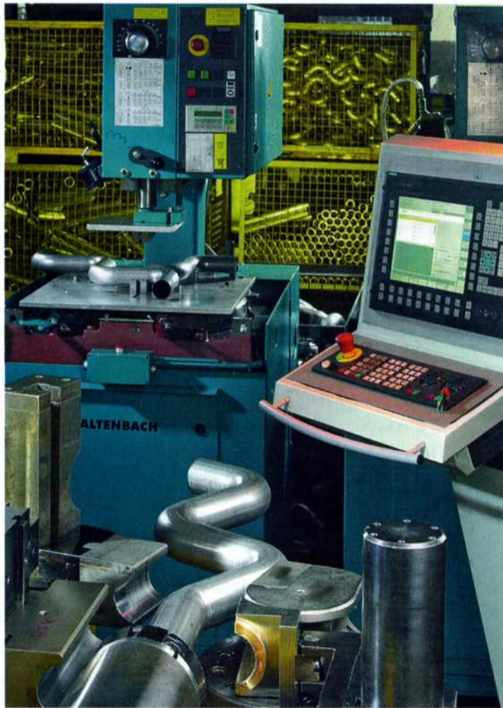
Aus einem Rohrstück werden immer zwei Endstücke gebogen (vorn). In einem weiteren Arbeitsgang werden diese getrennt (hinten)
