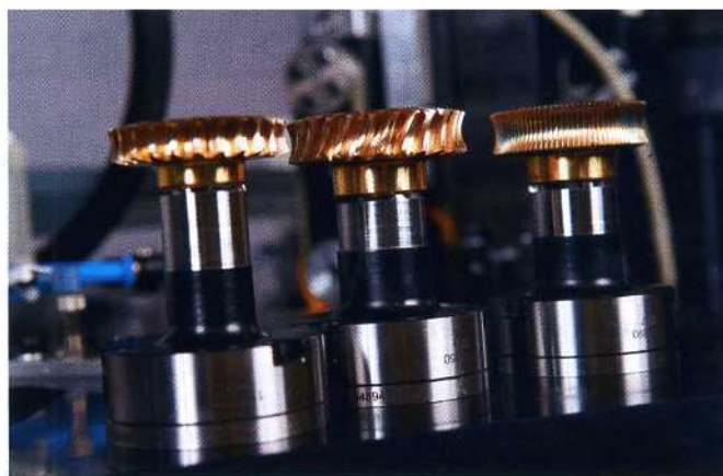
Federbetätigte Spanndorne von Röhm, die pneumatisch geöffnet werden, spannen die Werkstücke sicher.
