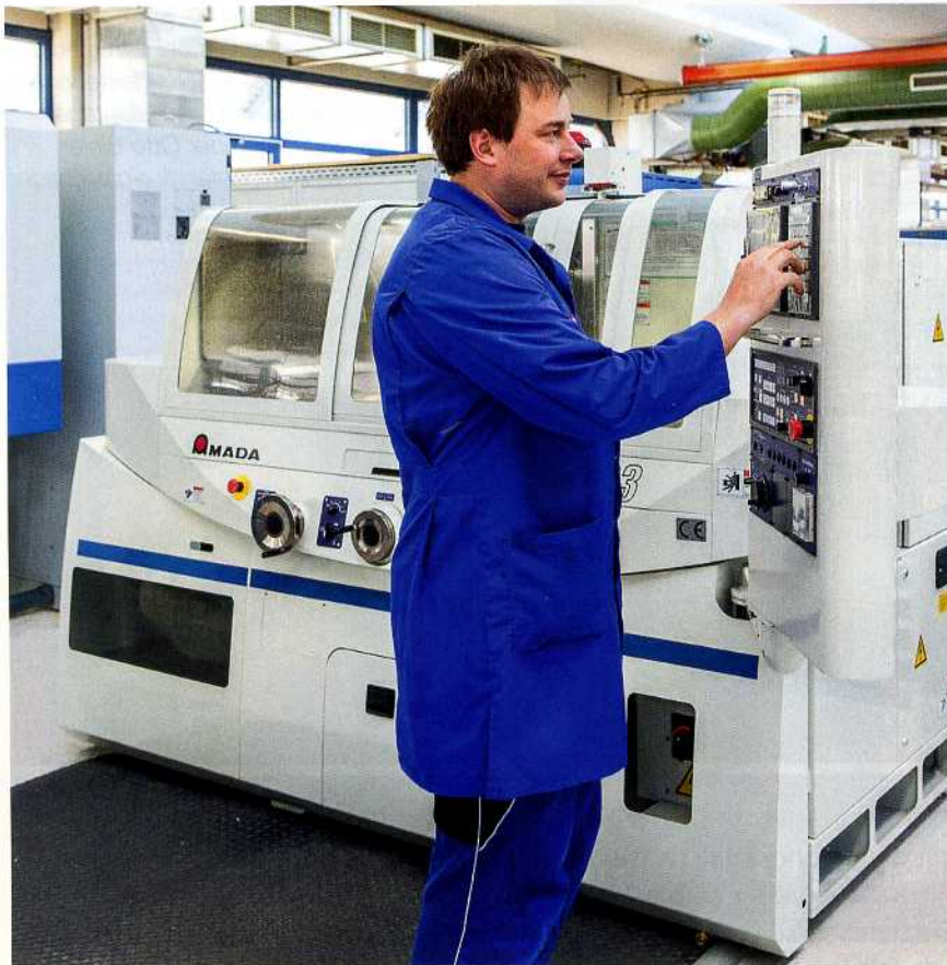
Bild 3: Neben der intuitiv bedienbaren Steuerung wurden die Handräder für schnelles Einstellen beibehalten
