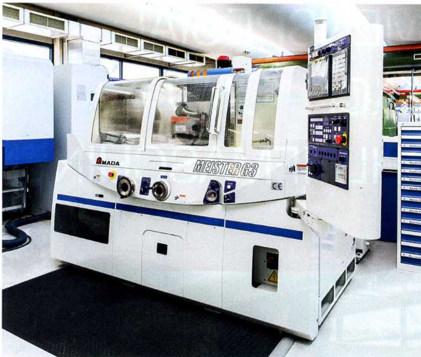
Bild 1: Die Schnellhub-, Flach- und Profilschleifmaschine übernimmt Arbeitsschritte, die früher auf drei Maschinen verteilt waren
