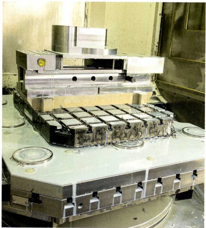
Bild 3: Die kraftvollen und kompakten Einbauspännmodule entwickeln Haltekräfte bis 55 kN.
