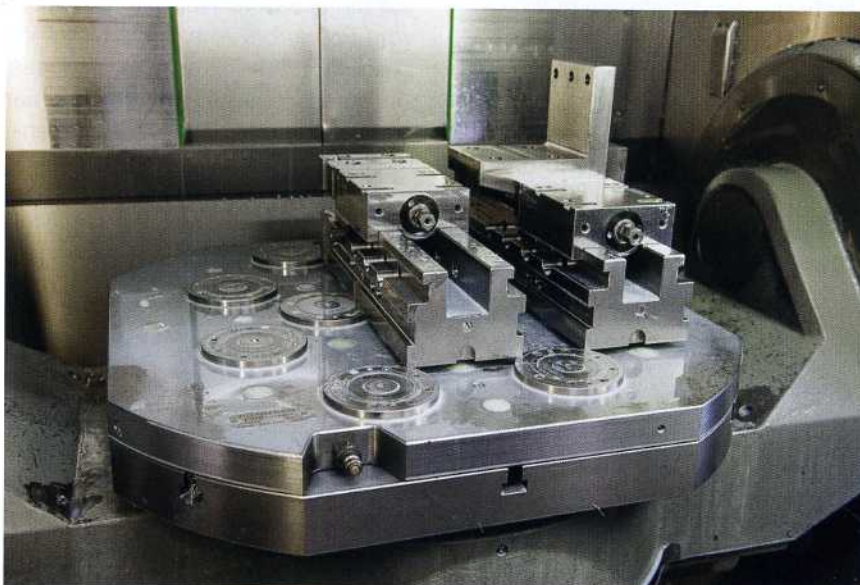
Bild 2: Mit den Nullpunktspannsystemen hat kocher-plastik 3 Ziele erreicht: Rüstzeiten senken, Rüstvorgänge vereinfachen, Rüst- vorgang außerhalb der Maschine
