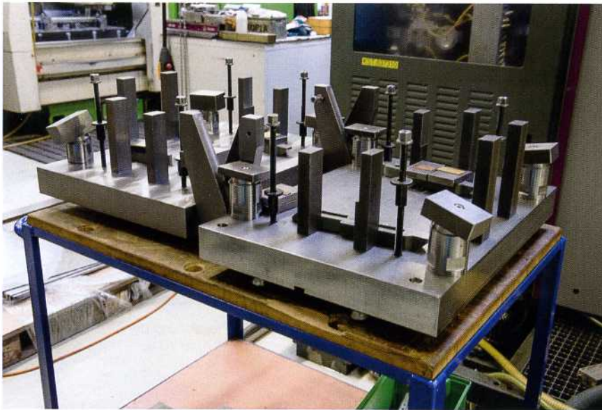
Bild 6: Die Grundplatte hat Spannippel an der Unterseite für schnelles Rüsten mit dem Nullpunktspannsystem. Neben den messbaren Verbesserungen haben die Mitarbeiter mit ihrer Kreativität und mit Ideen für weitere Verbesserungen gesorgt
