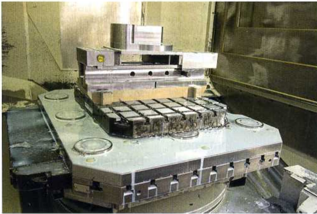
Bild 3: Die kompakten Einbau-Spannmodule entwickeln Haltekraft bis 55 kN
