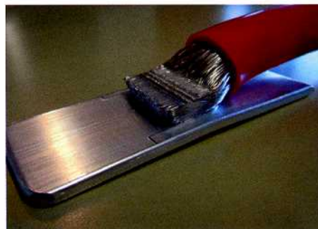
Beim Verschweißen von Litzen sind bis zu 30 Prozent schmalere und höhere Knoten möglich
