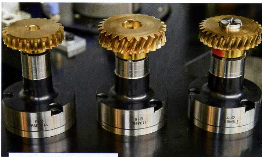
Zahnräder für Getriebe werden auf einer Ott Entgratstation gebürstet.
