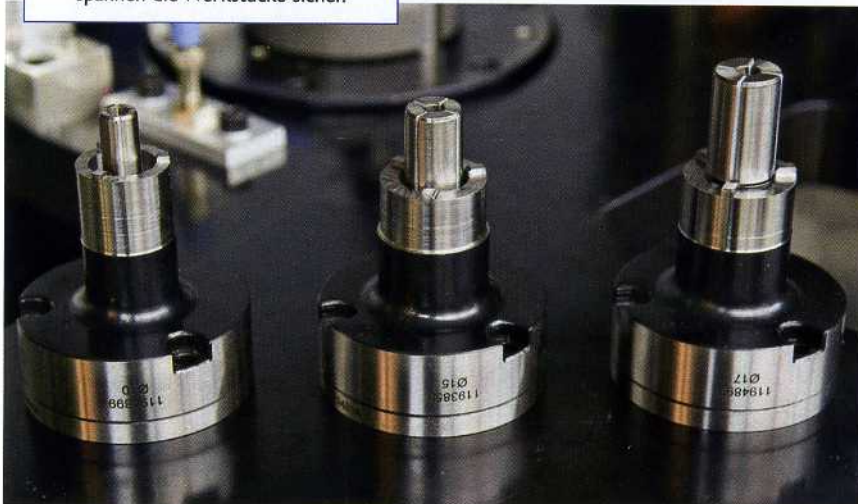
Federbetätigte Spanndorne von Röhmm, die pneumatisch geöffnet werden spannen die Werkstücke sicher.
