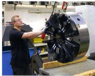
Das riesige 800 mm Futter lässt sich auch mit aufgesetzten InoZet-Pendelbrücken von Röhm bequem handhaben.
