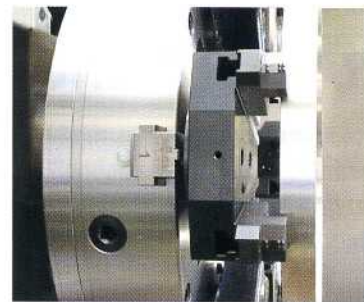
Vor allem bei der Herstellung der Seiteneinstiche bringen die zwölf Anlagepunkte spürbar mehr Präzision in den Prozess, weil das Material weniger ausweichen kann.
