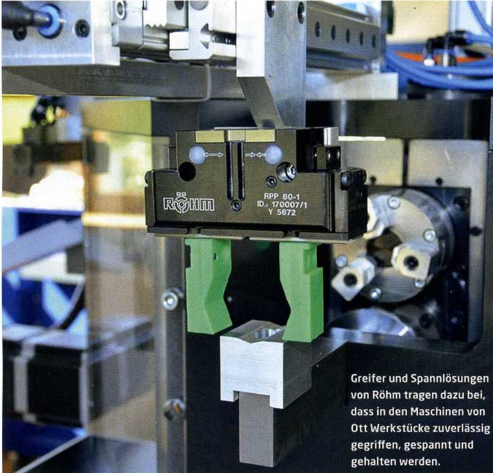
Greifer und Spannlösungen von Röhm tragen dazu bei, dass in den Maschinen von Ott Werkstücke zuverlässig gegriffen, gespannt und gehalten werden.
