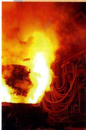
Stahlgießen in der Fertigungsanlage mit nahe gelegenen Hydraulikflüssigkeitsschläuchen.
