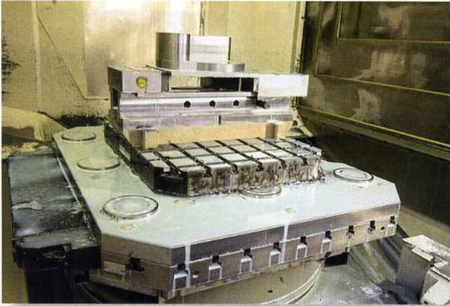
Bild 3: Die kraftvollen und kompakten Einbau-Spannmodule entwickeln Haltekräfte bis 55 kN
