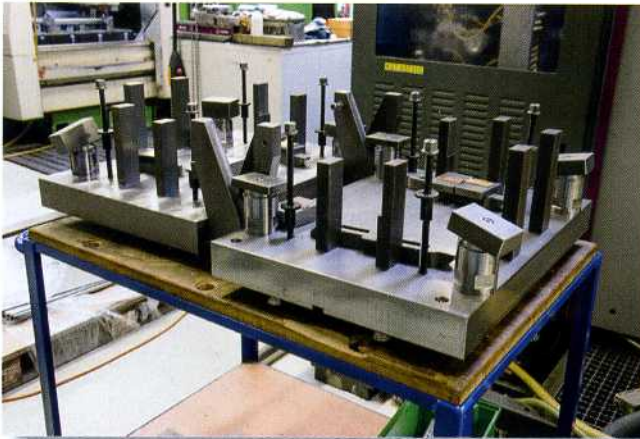
Bild 6: Die Grundplatte hat Spannnippel an der Unterseite für schnelles Rüsten mit dem AMF-Nullpunktspannsystem. Neben den messbaren Verbesserungen haben die Mitarbeiter mit ihrer Kreativität und mit Ideen für weitere Verbesserungen gesorgt
