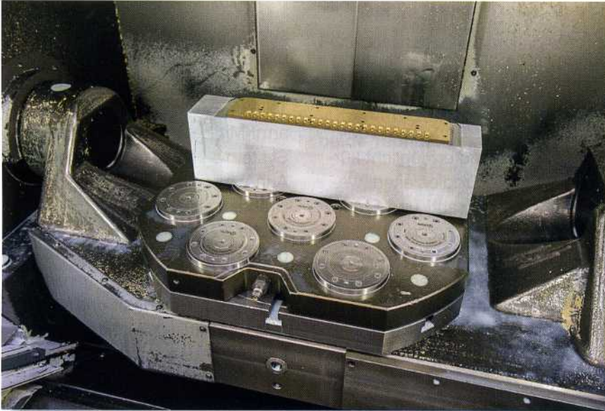
Bild 1: AMF Nullpunkt-Spannmodule K20 sorgen bei Kocher-Plastik für höhere Maschinenlaufzeiten
