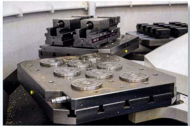
Bild 7: Rüstplätze außerhalb der Maschinen erhöhen die Auslastung der Maschinen bei Kocher-Plastik erheblich (Werkbilder: Andreas Maier GmbH & Co. KG, Fellbach)
