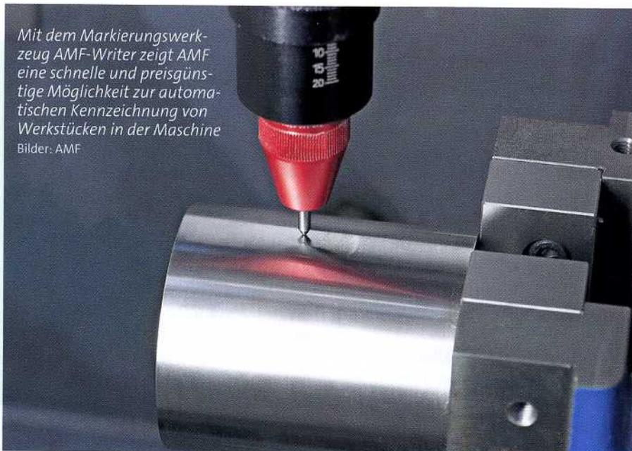
Mit dem Markierungswerkzeug AMF-Writer zeigt AMF eine schnelle und preisgünstige Möglichkeit zur automatischen Kennzeichnung von Werkstücken in der Maschine
