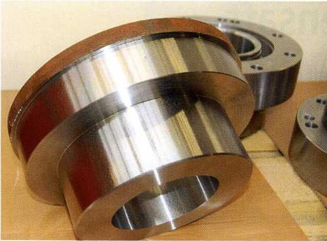
Es sind nur zwei Aufspannungen nötig, um die bis zu 550 kg schweren Rohteile zu Gleitlagern, Flanschen oder Spiraldichtungen für Pumpen zu bearbeiten
