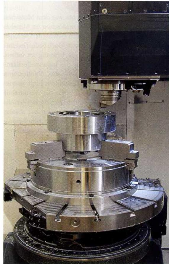
Beim neuen Zentrisch-Spannfutter »Duro-T« hat Röhm die Spannkräfte gegenüber dem Vorgängermodell noch einmal um ein Fünftel erhöht
