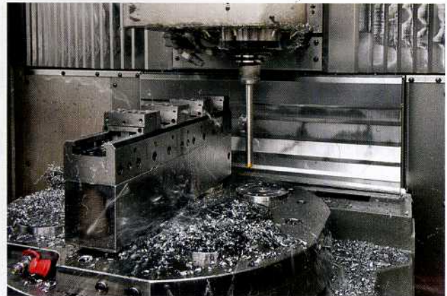
Bild 2: Das automatische Reinigungsgerät nutzt die Funktionen der Bearbeitungszentren für schnelles und preiswertes Reinigen und Trocknen (Werkbilder: Anrdeas Maier, Fellbach)
