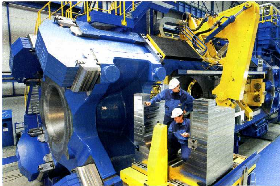
150 MN Großstrangpresse von SMS für die chinesische Yankuang Light Alloy Company
