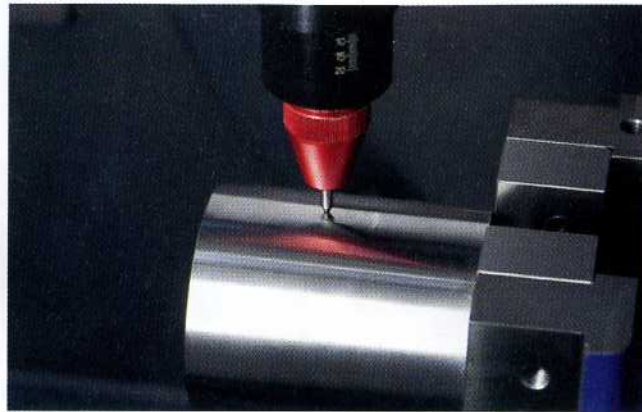
Mit dem AMF Writer lassen sich auch runde, schräge oder unebene Werkstücke kennzeichnen
