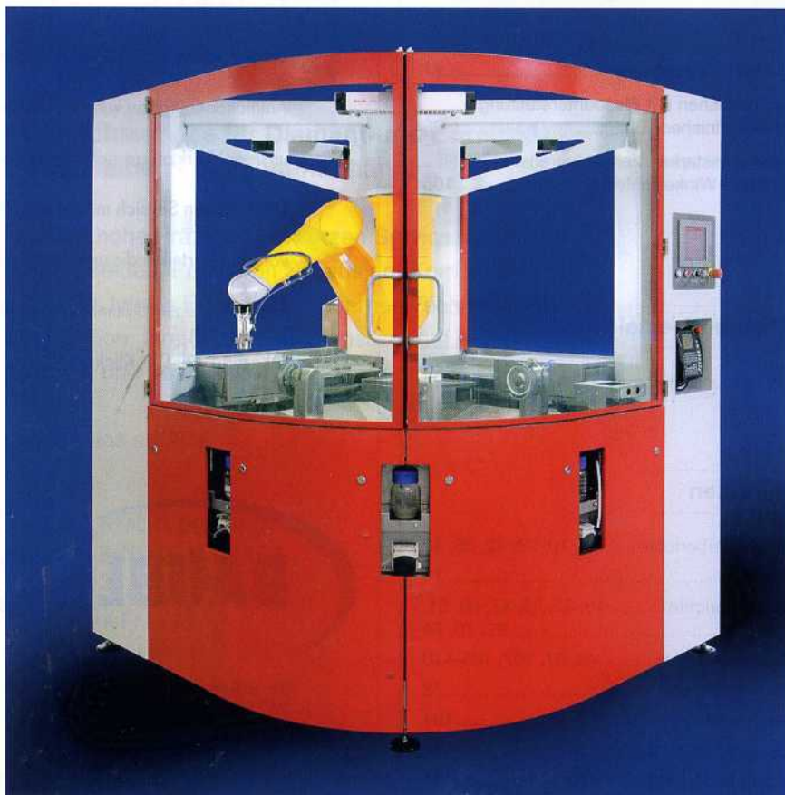
Bild 1: Anspruchsvolle Herausforderung: Die Zeltwanger Automation GmbH und die Oechsler AG bringen Keramik für Design- und Sichtteile in Premiumfahrzeugen mit einem neuen, automatisierten Polierverfahren auf Hochglanz
