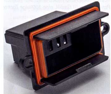
Steckverbindingsteil in 2K-Technik aus LSR und PA 6.6
