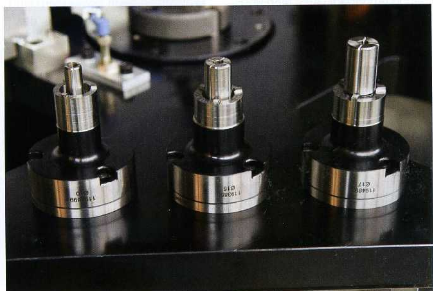
Bild 3: Federbetätigte Spanndorne von Röhml, die pneumatisch geöffnet werden, spannen die Werkstücke sicher
