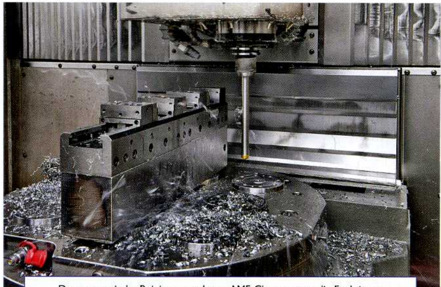
Das automatische Reinigungswerkzeug AMF-Cleaner nutzt die Funktionen von CNC-Maschinen und Bearbeitungszentren für schnelles und preiswertes Reinigen und Trocknen.
