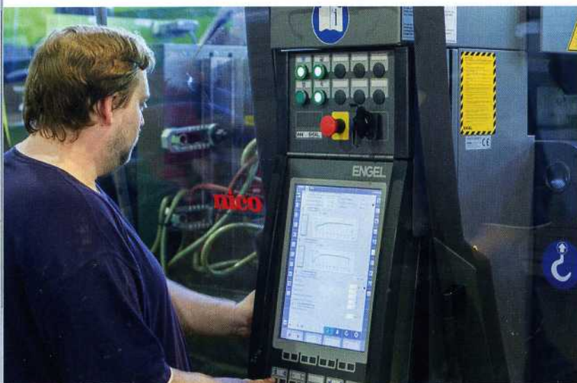
Bild 3: Durch den schnellen Werkzeugwechsel in zwei bis fünf Minuten gewinnt Nico bis zu drei Stunden Produktionszeit täglich
