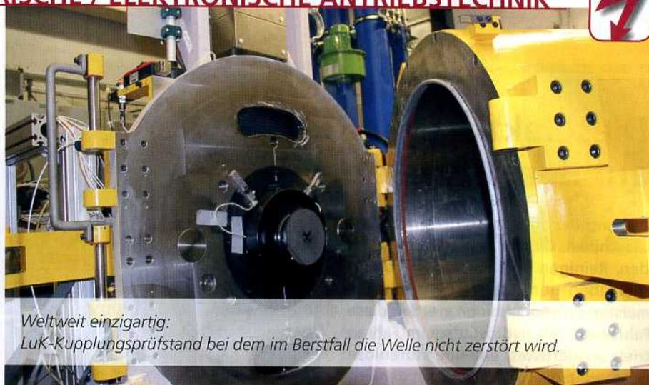
*Weltweit einzigartig: LuK-Kupplungsprüfstand bei dem im Berstfall die Welle nicht zerstört wird.*
