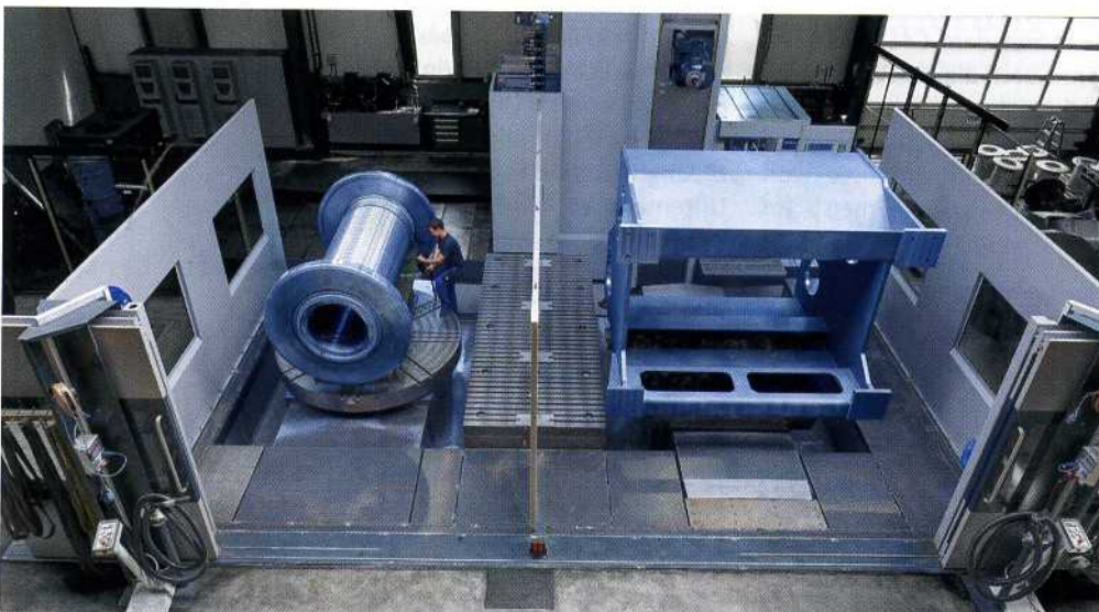
Bis zu fünf Meter lang und zwei Meter im Durchmesser messen die bis zu zehn Tonnen schweren Seiltrommeln aus Gusseisen oder Stahl, die auf dem SHW-BAZ fertigbearbeitet werden können.
