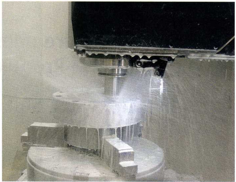
Bild 2: Die Rund- und Planlaufgenauigkeit des Spannfutters übertrifft die DIN-Vorgaben um den doppelten Wert.
