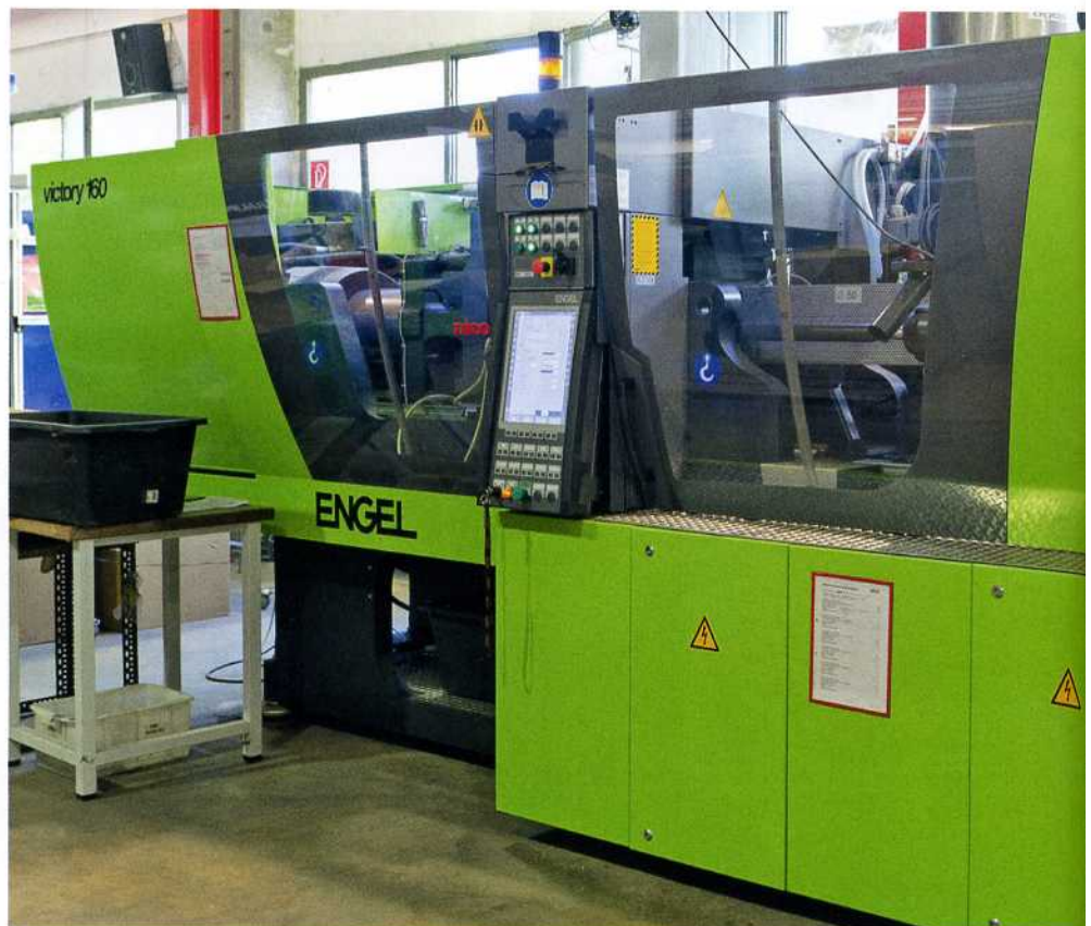
Durch Engel-Maschinen in Holmlos-Bauweise sichert sich Nico Wettbewerbsvorteile; die Produktion kommt mit Maschinen geringer Schließkraft aus und die Rüstzeiten wurden minimiert
