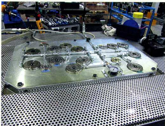
Aufnahmeplatten mit eingebauten Nullpunktspannmodulen von AMF warten auf die Prüflinge.
