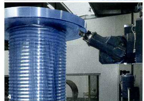
2 Die bis zu zehn Tonnen schweren Seiltrommeln lassen sich in maximal zwei Aufspannungen fertig bearbeiten. 3 Kernstück der SHW-Maschine ist der kraftvolle Orthogonalkopf. 4 Auf dem Dreh-Fräsbearbeitungszentrum von SHW fertigt Kienle Seiltrommeln.
