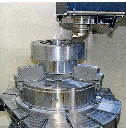
Die Rund- und Planlaufgenauigkeit des Duro-T ist doppelt so gut wie nach DIN-Genauigkeitsklasse 1 vorgeschrieben
