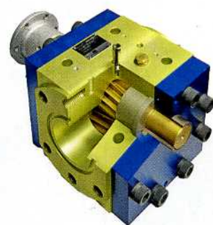
Der Clou der Pumpen von Maag Pump Systems liegt in der Schmierung der Gleitlager durch die Fördermedien selbst
