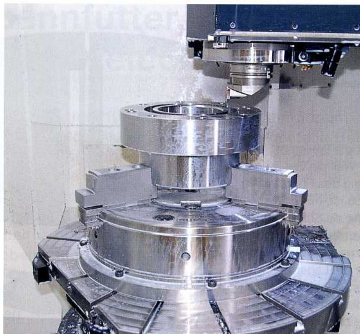
Bild 6: Die Rund- und Planlaufgenauigkeit des DURO-T ist doppelt so gut wie nach DIN-Genauigkeitsklasse 1 vorgeschrieben
