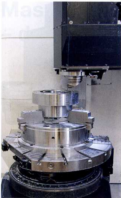
Bild 5: Röhms hat beim neuen Zentrisch-Spannfutter DURO-T die Spannkräfte gegenüber dem Vorgängermodell noch einmal um 20 % erhöht
