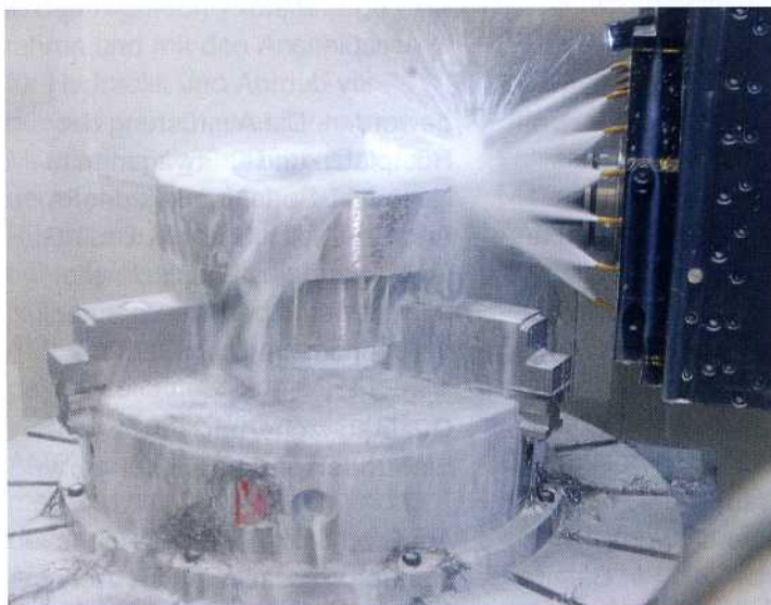
Bild 8: Die neu entwickelte Spritzwasserseite des Röhm-Futters lenkt das Medium optimal
