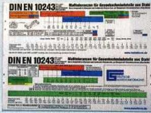
Der Industrieverband Massivumformung hat den Maßtoleranzschieber für Gesenkschmiedeteile aus Stahl neu aufgelegt. Dieser gibt den Inhalt der DIN EN 10243 inklusive Ergänzungen auf 30 Seiten mit einer Größe von 9 cm x 25 cm
