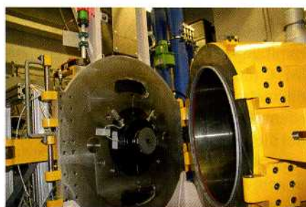
Einzigartig: Kupplungsprüfstand bei dem im Berstfall die Welle nicht zerstört wird.
