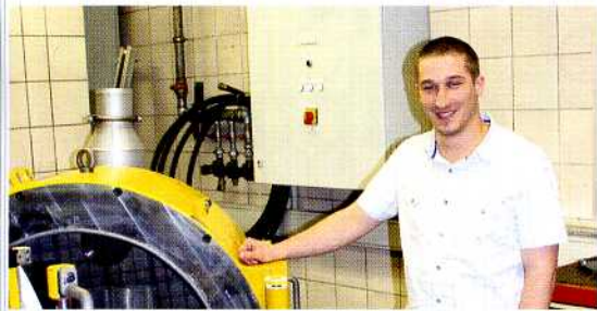
LuK-Konstrukteur Sebastian Berends: „Bisher gab es nur Prüfstände, bei denen im Berstfall die Antriebswelle zerstört wird. Das sollte bei dem neuen Konzept vermieden werden.“
