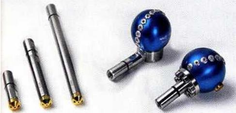
Mit dem AMF-Cleaner der Andreas Maier GmbH & Co. KG (AMF) können Anwender Werkstücke und Spannvorrichtungen sowie Werkzeuge und Maschinen während und nach der Bearbeitung vollautomatisch reinigen. Verschieden gestaltete Reinigungswerkzeuge wie Stick und Ball wechseln sich je nach Bedarf selbstständig in die Maschinenspindel von CNC-Maschinen ein und reinigen mit Kühlschmierstoff oder Druckluft.
