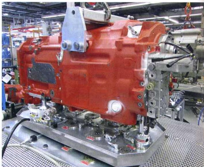
**Bild 8:** Die Spannmodule haben einen großen, selbstzentrierenden Fangeinzug, der die optimierte Kontur der Spann-Nippel mit Fangnippelschrauben auch bei einem schrägen Ansetzen verkantungsfrei aufnehmen und verriegeln kann
