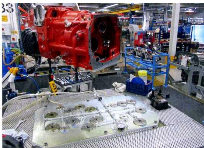
**Bild 3:** Für den Spannvorgang muss der Prüfling lediglich auf das für ein verwechslungssicheres Spannen farblich und mit Kodierungen gekennzeichnete Muster aus AMF-Einbauspännmodulen abgesetzt werden
