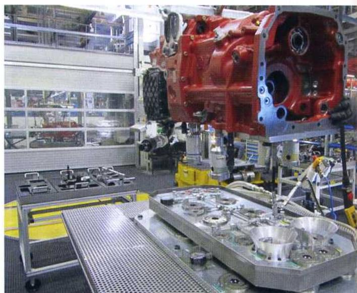
und mit dem Lösedruck von 50 - 60 bar beaufschlagt, so dass das fertig geprüfte Getriebe abgehoben werden kann
