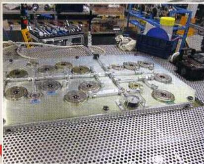
Aufnahmeplatten mit eingebauten Nullpunktspannmodulen von AMF warten auf die Prüflinge.
