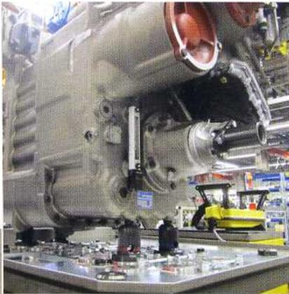
Mit AMF-Nullpunktspanntechnik wird auch das 1,9 Tonnen schwere stufenlose Hightech-Getriebe Eccom 4.5 gespannt, das für eine effiziente Umsetzung der in den Xerion-Schleppern von Claas installierten 400-kW-Motoren sorgt.
