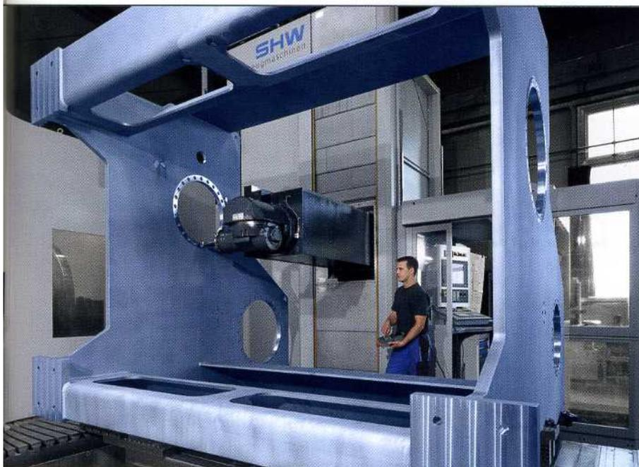
2 Kernstück der SHW-Maschinen ist ein kompakter, kraftvoller Orthogonalkopf, der 64 800 Positionen schnell und positionsgenau anfahren kann
