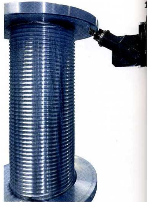
1 Auf dem Dreh-Fräs-BAZ von SHW fertigt Kienle Seiltrommeln, die bis zu 5 m in der Länge, 2 m im Durchmesser und 150 mm in den Wandungen messen
