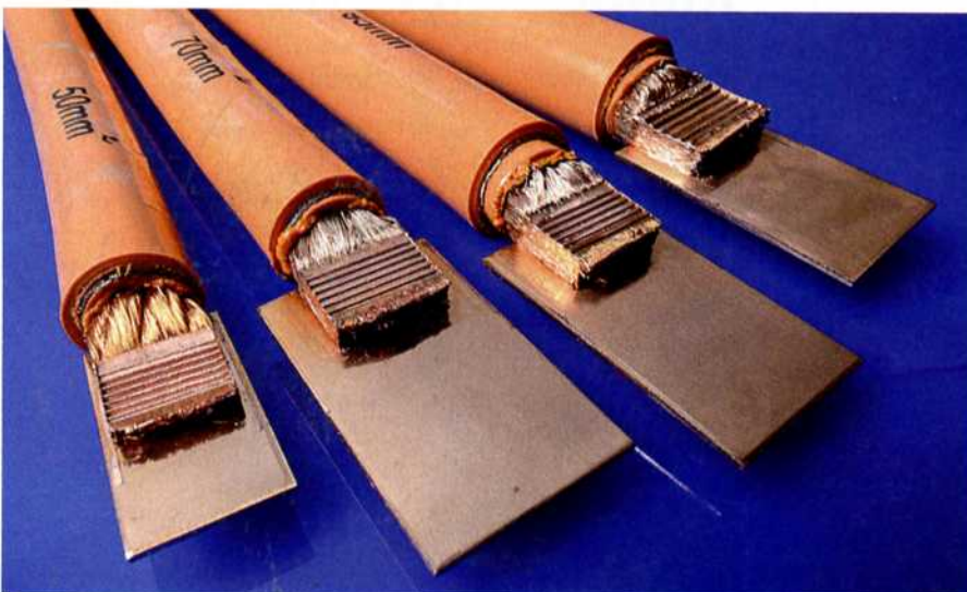
Mit der sogenannten Power-Wheel-Technik können wesentlich größere Kräfte und Leistungen als bisher in die Schweißung eingeleitet werden.
