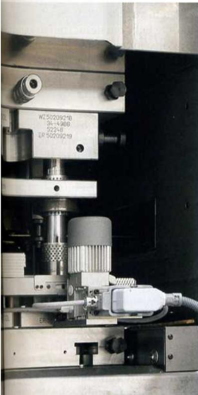
Zur optimierten Ausbringung von Teilen und Butzen hat Feintool ein modulares Räumsystem entwickelt, das mit nur minimalen Werkzeuganpassungen im Normalfall eine gleiche oder bessere Performance als das Ausblasen erreicht.
