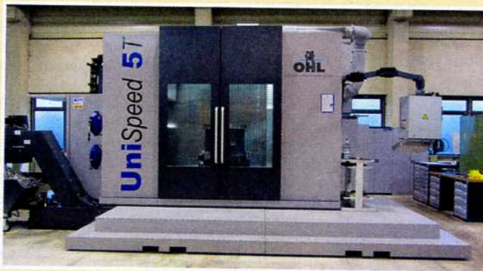
Das Dreh-/Fräszentrum UniSpeed 5T deckt Verfahrswege von X = 2 000 mm, Y = 1 300 mm und Z = 1 300 mm ab und kann bis zu 6 t schwere Werkstücke bearbeiten.
