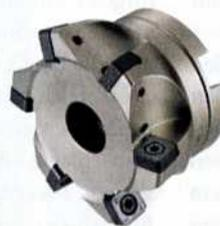
Die Wendeplatten des neuen Planfräskopfes Multiedge Double 4Feed von LMT Fette sind beidseitig einsetzbar. Dadurch wird die Anzahl der nutzbaren Schneiden je Wendeplatte auf acht erhöht. Beim Planfräsen von Stahl- und Gusswerkstoffen
