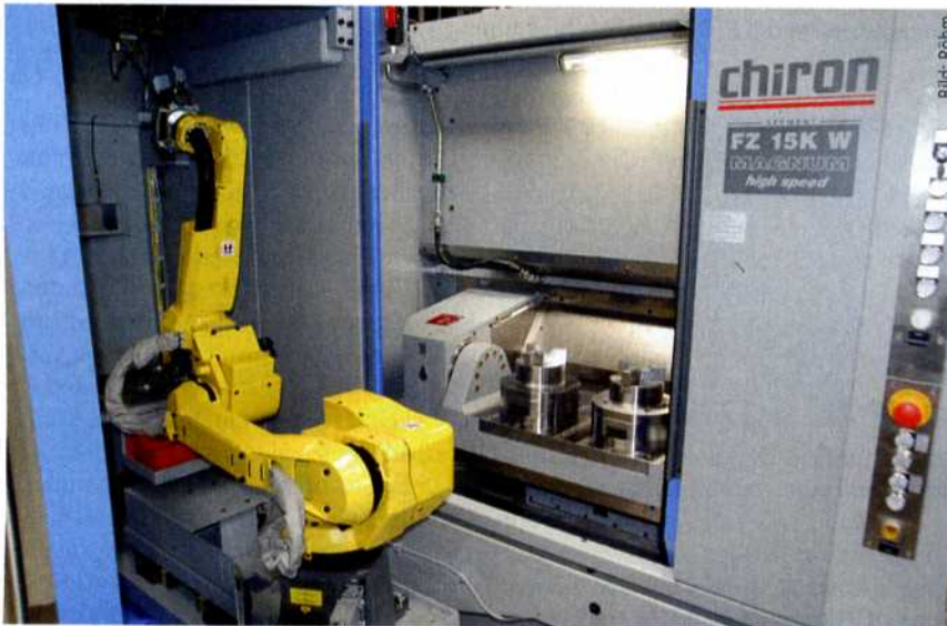
Das neue Fertigungszentrum Chiron FZ 15 Magnum mit FlexCell-Uno-Roboter von Fanuc ermöglicht mit Röhм Spanntechnik mannlose Geisterschichten.
