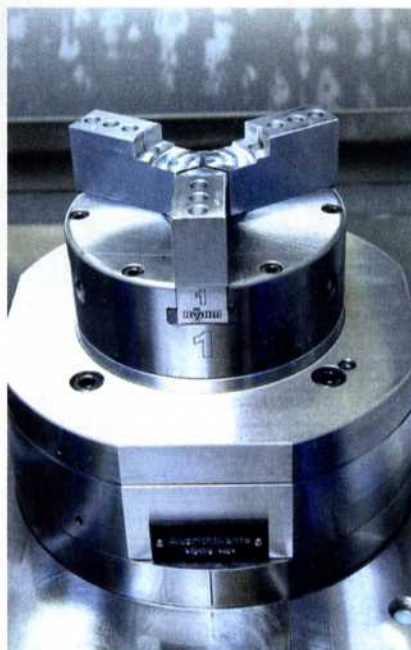
Das Röhmspannfutter spannt auch leicht verformbare Werkstücke.
