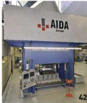
42 Das IFU hat erstmals in Europa eine Aida-Presse mit Servo-Ziehkissen installiert.
