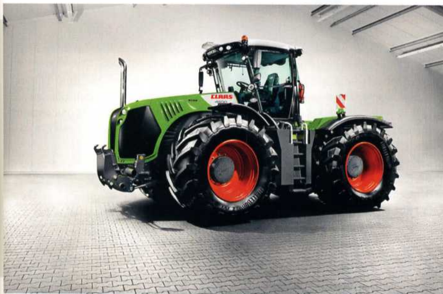
Bis zu 2300 Nm Antriebsdrehmoment bringen den Schlepper mit permanentem Allradantrieb stufenlos von null auf 50 km/h – und das vorwärts wie rückwärts Bild: Claas
