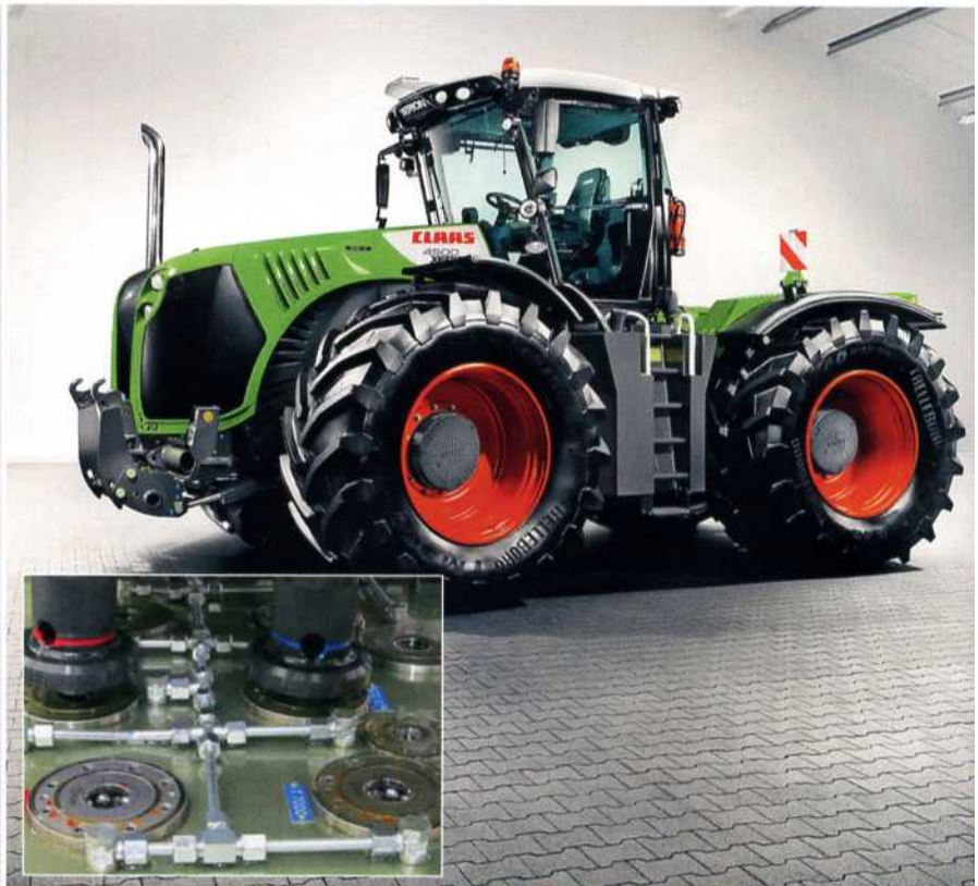
In einer Prüfanlage bei ZF in Passau sorgen AMF-Nullpunkt-Spannsysteme für schnelles Auf- und Abrüsten großer Getriebe für Traktoren und Baumaschinen ▶ 56
