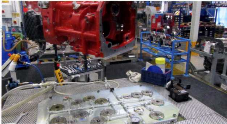
Die farblich gekennzeichneten Module nehmen die passenden Fangnippelschrauben sicher auf, die sich am unteren Ende der Aufnahmefüße befinden
