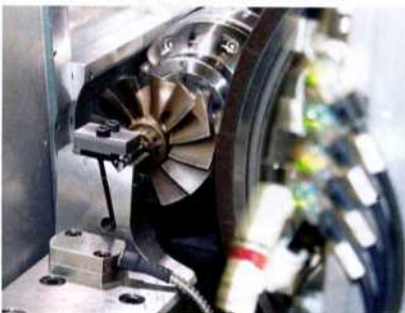
Bild 5: TECNO.team hat für den speziellen Einsatz die passenden CBN-Schleifscheiben zusammen mit dem Hersteller entwickelt (Werkbilder: TECNO.team GmbH, Eislingen)
