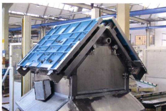
Zwei Rohteile werden gegeneinander aufgestellt, wobei eines auf der Oberseite und eines auf der Unterseite bearbeitet wird. So entsteht bei jedem Durchgang ein Fertigteil.
